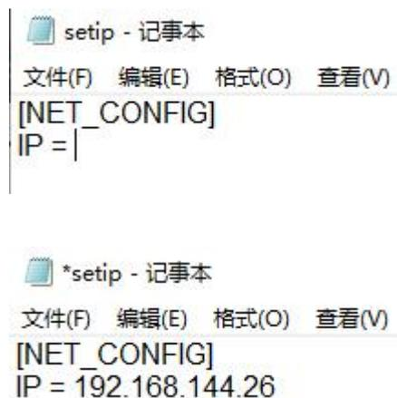
将 SD 卡重新插入卡录摄像头并重启摄像头，且等待三到五分钟后，SD 卡内的 IP 地址会完成刷写。之后再次重启摄像头，IP 地址即可改写成功。
