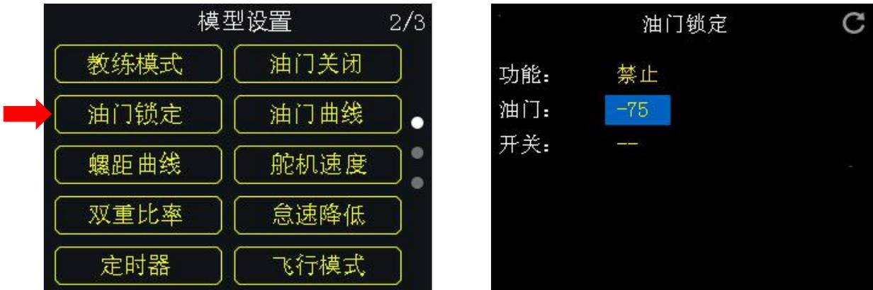
FT24 支持设置油门锁定功能，当启用油门锁定功能后，油门通道行程量强制固定已设置的值，推动油门摇杆输出无效，关闭此功能则恢复正常。
