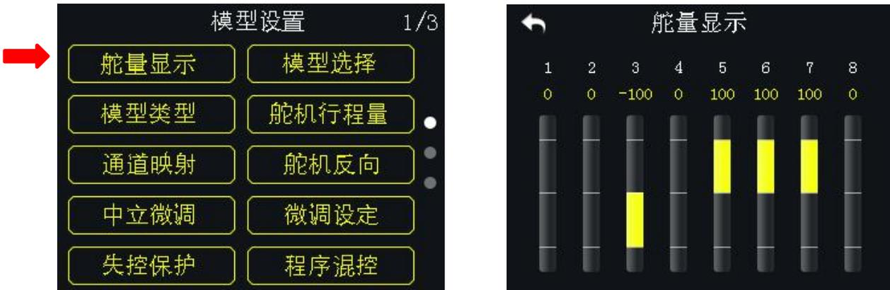
通过舵量显示功能下的通道监视器，在对遥控器进行过一系列通道设置后，用户可以实时查看所有 16 通道输出值的变化。
