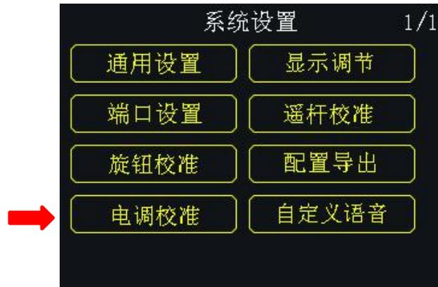
用户可将所有需要校准的电调连接至接收机 1-8 PWM 接口，根据遥控器提醒步骤操作即可完成校准，省去单个校准的繁琐步骤。
