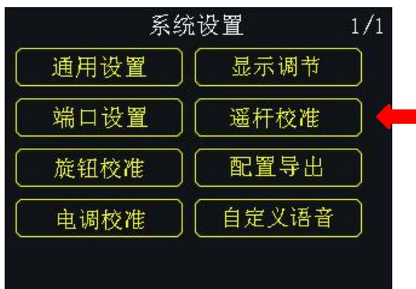
用户可通过此功能校准摇杆的中立位置。当摇杆行程量未在中立点或无法到达最大最小时，需要重新校准摇杆，定期校准摇杆有助于保持摇杆的控制精度。
