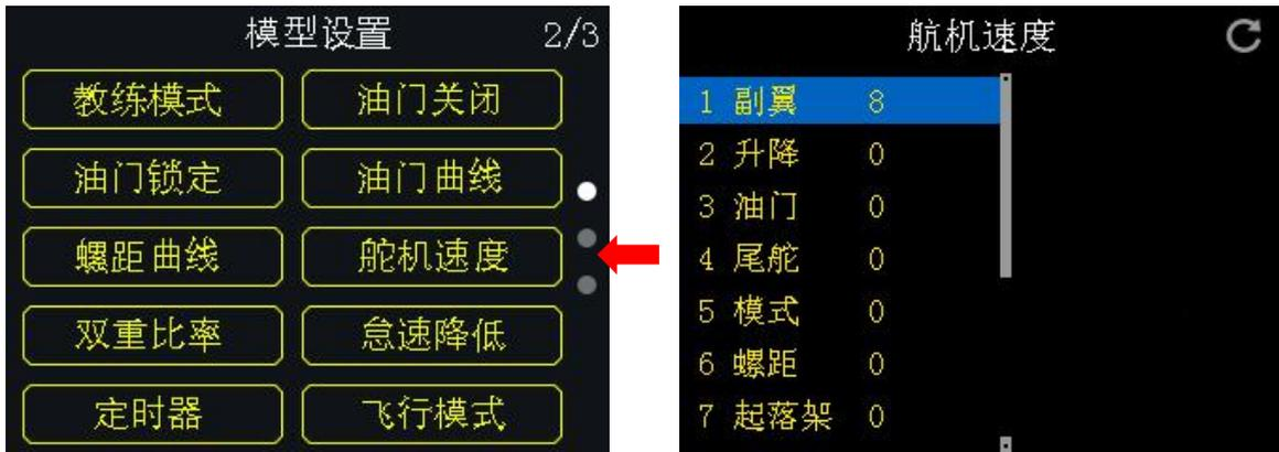
舵机速度：通过调整输出通道的变量，来完成一些特殊的效果，如起落架我们需要一个缓慢收放动作效果，正常的参数收放速度非常快，增加对应通道的变量，值越大动作输出着越慢。
