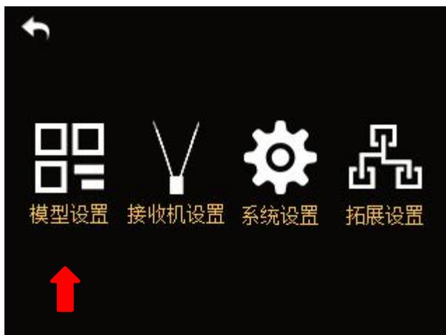
FT24 遥控器模型设置菜单下包含一系列遥控器功能菜单，用户通过各个功能菜单对所选模型类型进行基础设置和高级设置。
