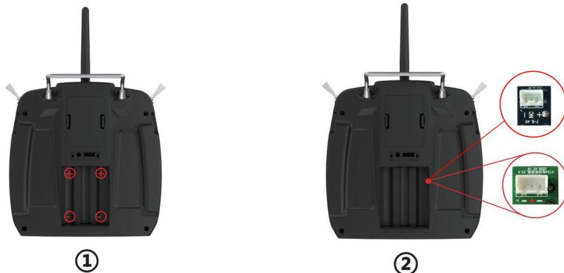
● 注释：使用 Lipo 电池连接时，请注意接口处正负极定义，黑色板子可直接插入 2S 电池平衡插头接口供电，绿色板子不得使用 2S 电池平衡插头直接供电，请按接口定义制作插头连接。
