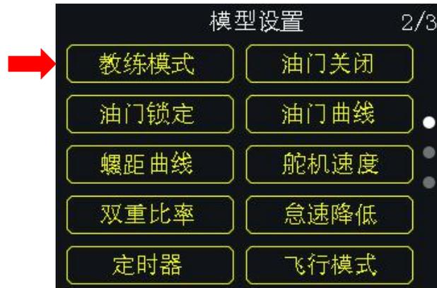
FT24 遥控器具有可编程教练功能以供老手对新手教学，两个遥控器之间可通过音频线或无线连接，用户可自行选择执行教练的通道。教练模式下，遥控器支持物理开关控制，可以实现一键切换教练机和学生机。
