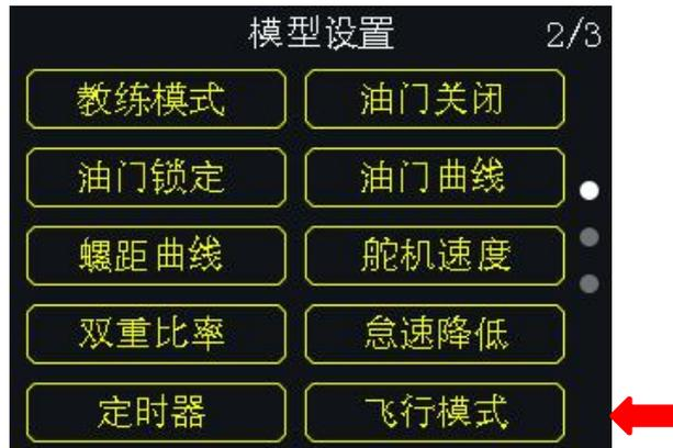
FT24 集成 6 挡飞行模式，适用于 APM\PIX 等飞控设置飞行模式，相比以往通过程序混控设置更为简单方便操作。
