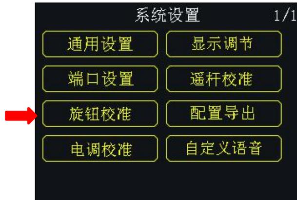
用户可通过此功能对拨轮进行校准以保持拨轮的精准输出。若发现遥控器拨轮在自然状态下不在中位（通道输出值不为 0）或者滚动到极限位置时达不到最大量程，请校准拨轮。
