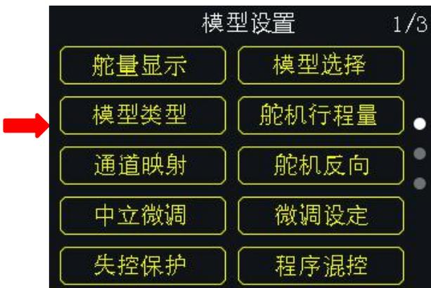
FT24 遥控器内置多种模型类型，固定翼/滑翔机、多旋翼（穿越机）和多模型（直升机）等类型。在遥控器中我们已为每种机型预设好必要的混控设置，正式使用之前，用户需要选择正确的模型类型并根据需求设置其他参数。
