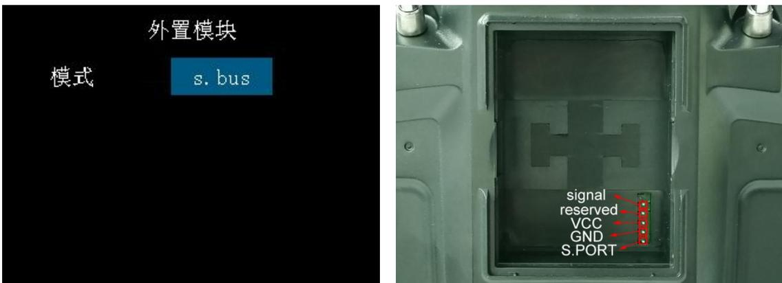
将模式选为 s. bus/ppm 模式下，外置高频头 signal 针脚对外输出信号。
