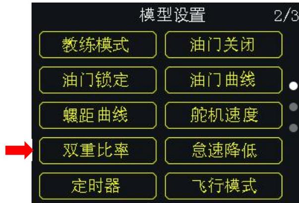
FT24 支持副翼、升降、方向通过拨动开关减少/增加舵机行程量，也可以通过预设三种比率达到多种飞行手感。
