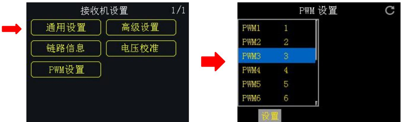
在 FT24 遥控器上可以重新定义 FR 接收机 PWM 模式下的输出通道（默认为 1—8），用户可重新定义 PWM 接口 1-8 以输出遥控器通道 1-16。
