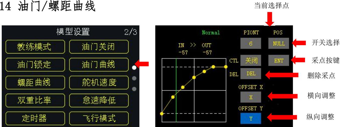
为了在操作油门摇杆获得更佳细腻的飞行手感，FT24 支持 3 组曲线功能，每组支持最大 6 点可调整
