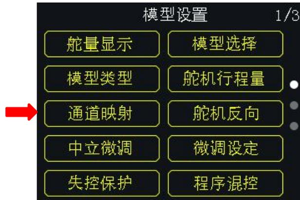
FT24 遥控器所有通道可任意映射遥控器上的摇杆、开关、按键、旋钮等。
