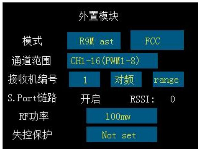
将 R9M 高频头接入遥控器，在模式中改选为 R9M 模式，遥控器即可与高频头通信，查看信号质量设置相关参数。s. bus/ppm 信号。
