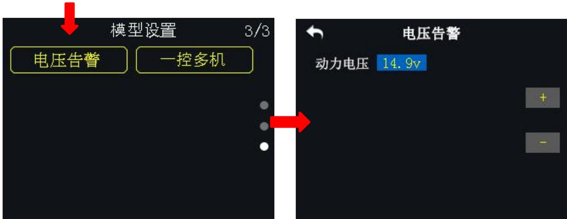
借助于 FT24 遥控器的电压回传功能，用户可设置电压告警功能。当飞行器动力电压低于安全水平时，遥控器发出语音提示。
