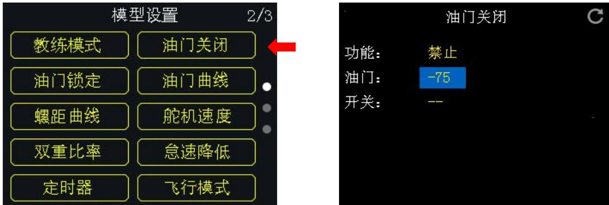
FT24 支持设置油门关闭功能，当启用油门关闭功能后，油门通道将固定已设置的值，推动油门摇杆输出无效，关闭此功能则恢复正常。
