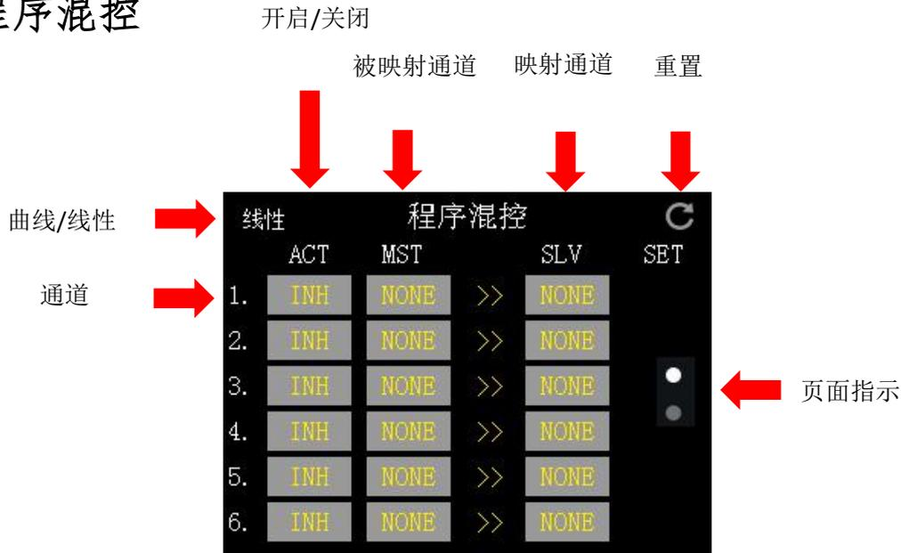
FT24 内置 10 路程序混控功能，其中 1-6 位线性混控，7-10 为曲线混控，您可通过混控功能设置更多复杂需求。
