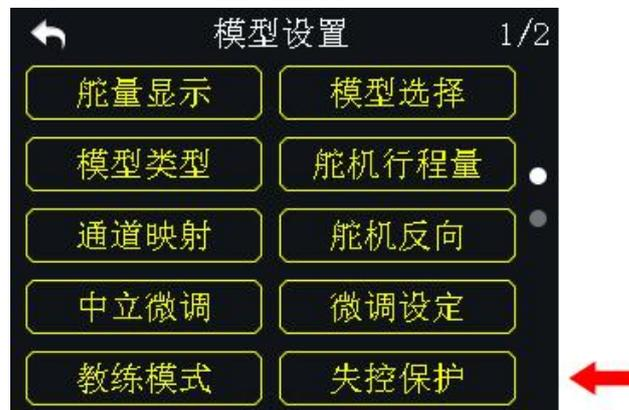
FT24 遥控器在进行对频操作前，接收机需要预先编入失控保护程序以开启失控保护功能，这样若遥控器和接收机之间失去连接，接收机立即运行预先设置的失控保护参数。
