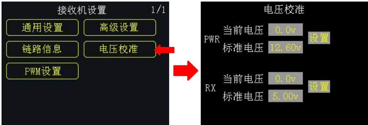
在使用 FR 接收机前，我们建议用户手动校准一次接收机 RX 回传电压和 Pwr 电压。在进行校准之前，请做好以下准备工作：
