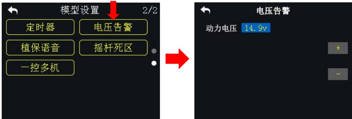
借助于 DK32 遥控器的电压回传功能，用户可设置电压告警功能。当飞行器动力电压低于安全水平时，遥控器发出语音和震动提示。
