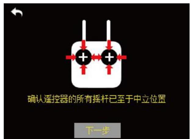
3. 点击“开始校准”，屏幕界面提示“确认遥控器的所有摇杆已置于中立位置”；
