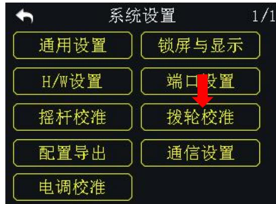
用户可通过此功能对拨轮进行校准以保持拨轮的精准输出。若发现遥控器拨轮在自然状态下不在中位（通道输出值不为 0）或者滚动到极限位置时达不到最大量程，请校准拨轮。
