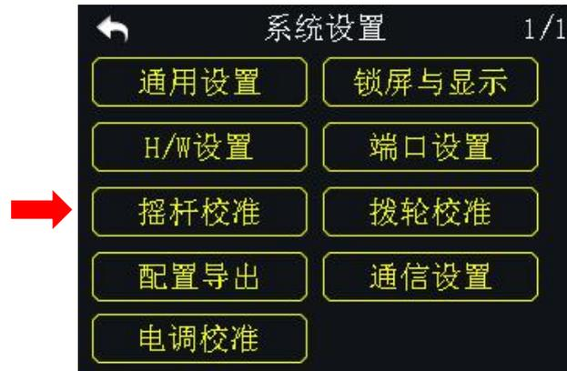
用户可通过此功能校准摇杆的中立位置。当发现摇杆控制精度降低，比如不能推动到最大位置或自然状态下不在中立位置时，需要重新校准摇杆。定期校准摇杆有助于保持摇杆的控制精度。
