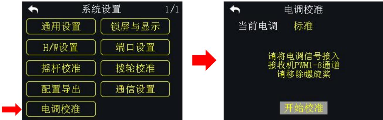
用户可将所需要校准的电调分别连接至 DK32 天空端 PWM 接口 1-8，跟随遥控器步骤提醒操作即可完成校准，极大简化了使用传统方式逐一校准电调的繁琐步骤。
