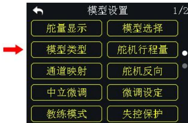
DK32 遥控器内置多种模型类型，固定翼/滑翔机、多旋翼（穿越机、植保机）和多模型（直升机）等类型。在遥控器中我们已为每种机型预设好必要的设置。
