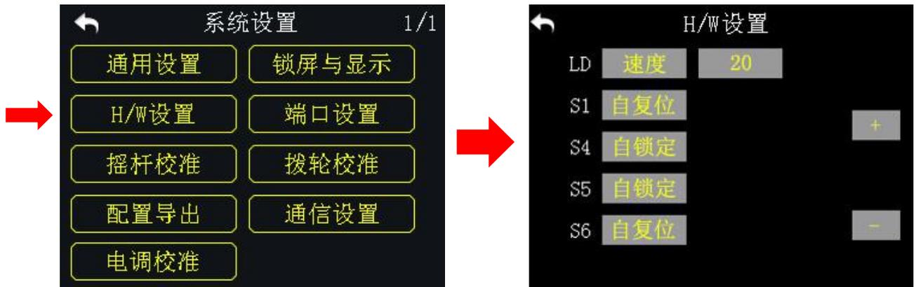
用户可通过此功能进行遥控器“滚轮”和“按键”的高级设置，以切换滚轮 LD（位置/速度）和按键 S1/S4/S5/S6 的工作模式（自锁定/自复位）。
