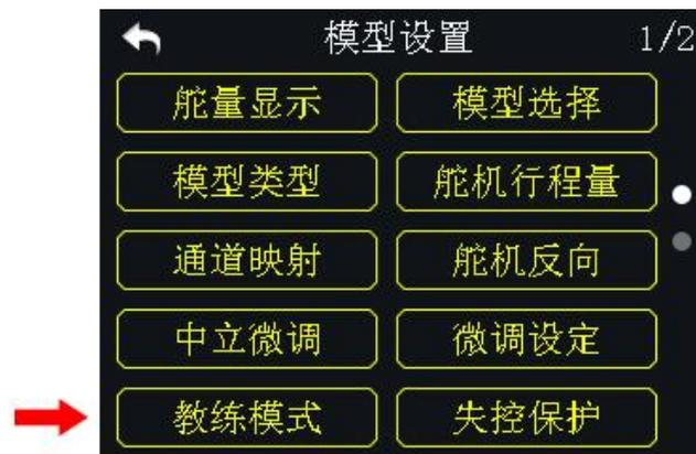
DK32 遥控器具有可编程教练功能以供老手对新手教学。两个遥控器之间可通过教练线连接。用户可自行选择执行教练的通道。
