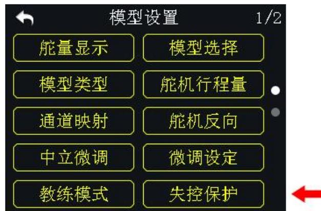
DK32 遥控器在进行对频操作前，天空端需要预先编入失控保护程序以开启失控保护功能，这样若遥控器和天空端之间失去连接，天空端立即运行预先设置的失控保护参数。
