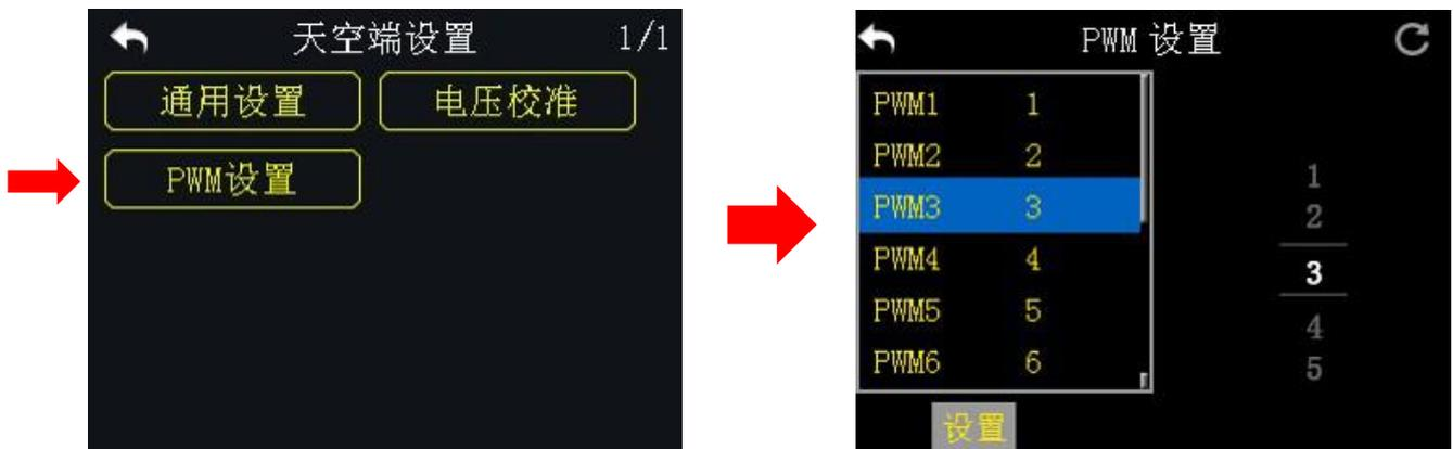
在 DK32 遥控器上可以重新定义 DK32 天空端 PWM 模式下的输出通道（默认为 1—9），这样若天空端第 9 通道已经在 SBUS 或者 PPM 模式下正常输出，用户可重新定义 PWM 接口 1-8 以输出遥控器通道 1-16。
