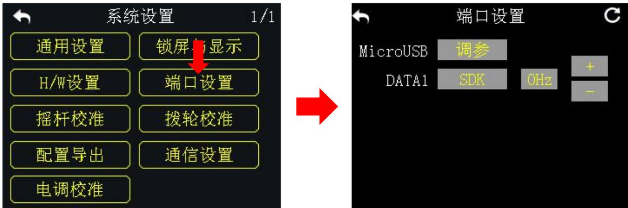
用户通过此功能可实现扩展遥控器功能到外部硬件设备和 SDK，目前支持的输出端口有 Micro-USB、USB 和 DATA1 等。
