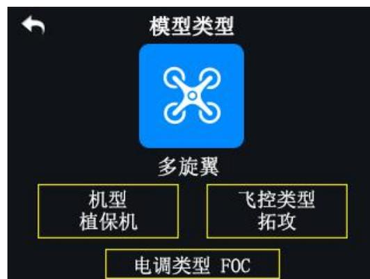
DK32 遥控器支持一键配置植保机参数。用户可根据自己所购买的飞控和电调选择对应的飞控类型和电调类型。选择飞控类型后，所选飞控对应的开关、按键、摇杆功能，植保语音播报功能及数传功能也会一并自动设置完成，实现到手即飞！
