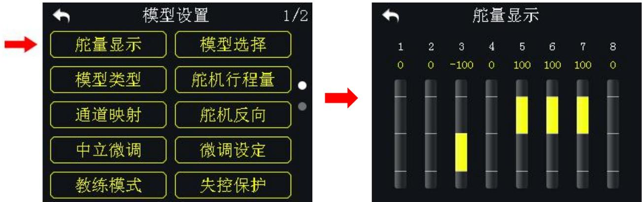
通过舵量显示功能下的通道监视器，在对遥控器进行过一系列通道设置后，用户可以实时查看所有 16 通道输出值的变化。
