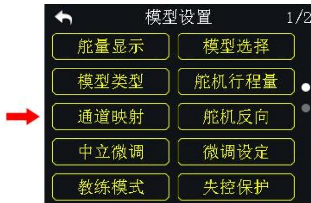
DK32 遥控器所有 16 通道可任意映射遥控器上的摇杆、开关、按键、拨轮等。
