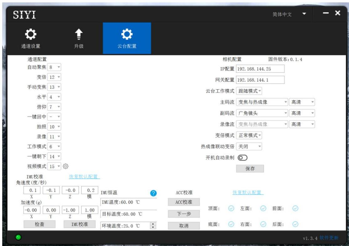
7. 在通道配置选项下，分配所需的遥控器通道（1~16）给对应的云台和相机功能。
